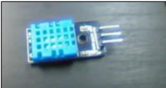
Figura 45→ Sensor Temperatura / Humedad Ref. DHT11
