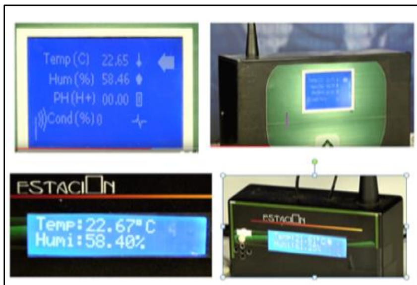
Figura 47→ Fotos temperatura humedad conductividad y pH en display LCD a Intel Galileo
