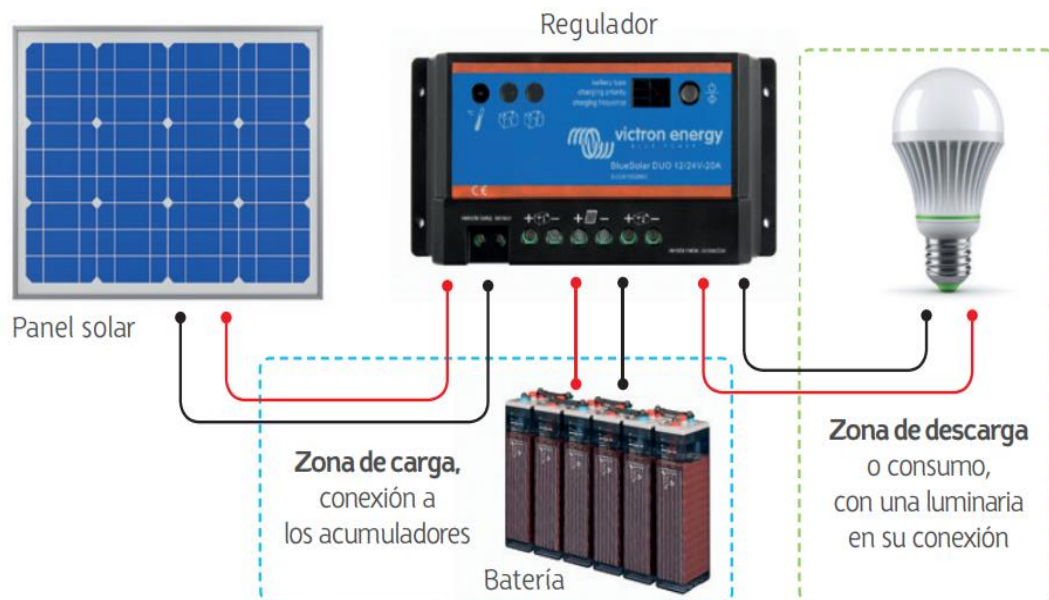
Figura 8. Conexión de un controlador en un sistema fotovoltaico. Fuente: (Díaz Corcobado & Carmona Rubio, 2018)
