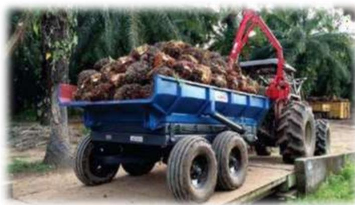
*Ilustración 91.* Transporte de fruto con maquina Grabber a planta (Capacidad de 4 a 7 Ton). (GREPALMA)
