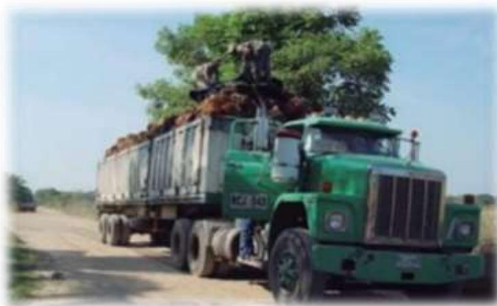
*Ilustración 94.* Doble troques de carga (Capacidad de 38 a 40 Ton). (Fedepalma)
