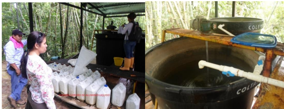
Figuras 15 y 16. Mezcladores de oxiclورو de Aluminio y agua con soda cáustica (Quebrada la Tablona)
