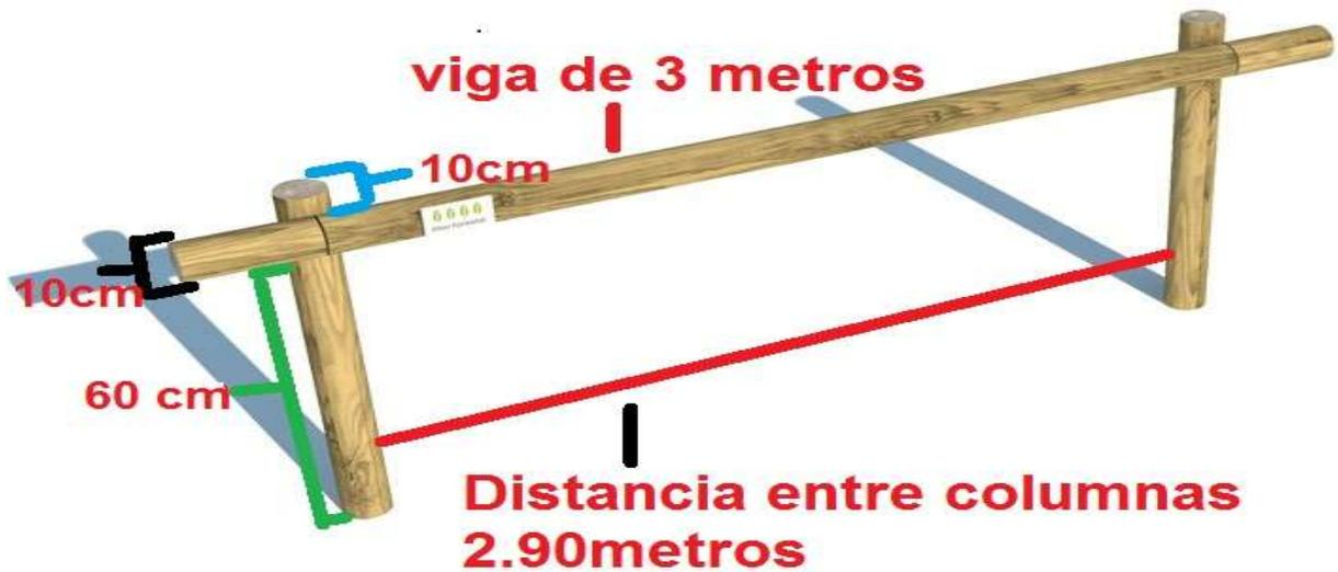
*Ilustración 3:* Marco que Soporta el Piso con sus respectivas dimensiones
