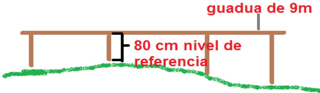
*Ilustración 5:* Ejemplo de Construcción en un Terreno Irregular
