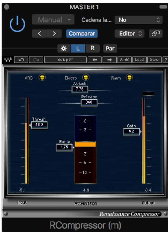
Por último, se realizó el proceso del **Limitador** que nos permitió controlar el rango dinámico de nuestra señal, es un compresor con compresión más alta que uno común, además de tener un attack y reléase muy rápido, este no permite dejar pasar la señal de un nivel máximo. Permitiendo reducir el rango dinámico y aumentar el nivel general de la mezcla.
