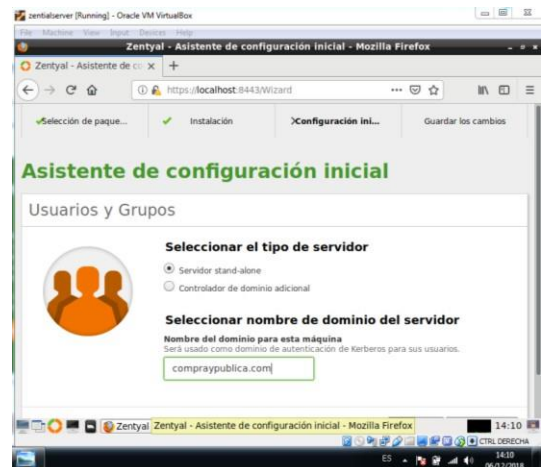
Figura 30. Grupos y Usuarios con servidor stand-alone y nombre del dominio para la red.
