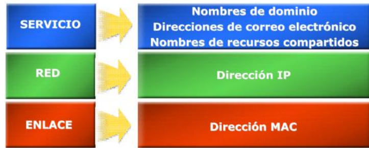
Figura 29 Validadores suplantables mediante spoofing
