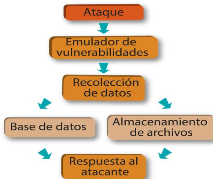
Ilustración Honeypot, Fuente: ESPINOSA, Oscar. “Qué es y para qué sirve un Honeypot”. {En línea} {Marzo 8 de 2020} disponible en: ( https://www.redeszone.net/tutoriales/seguridad/que-es-honeypot/ ).
