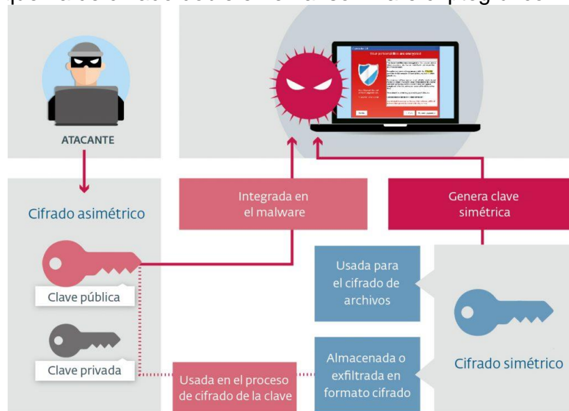
Figura 6. Esquema de cifrado doble en el ransomware criptográfico
