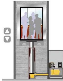
Figura 4 Ascensor Hidráulico
