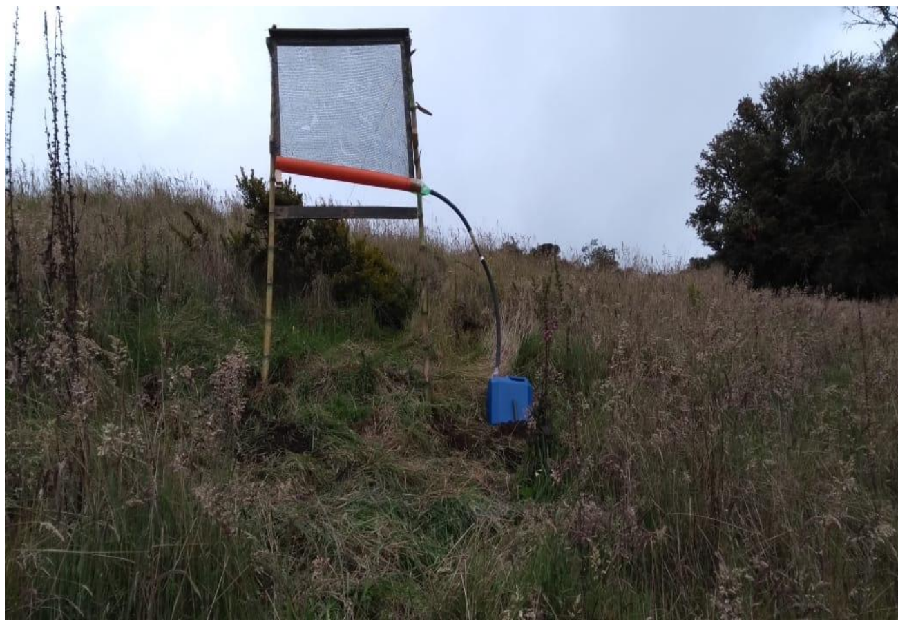
Colector de niebla tipo arpa
