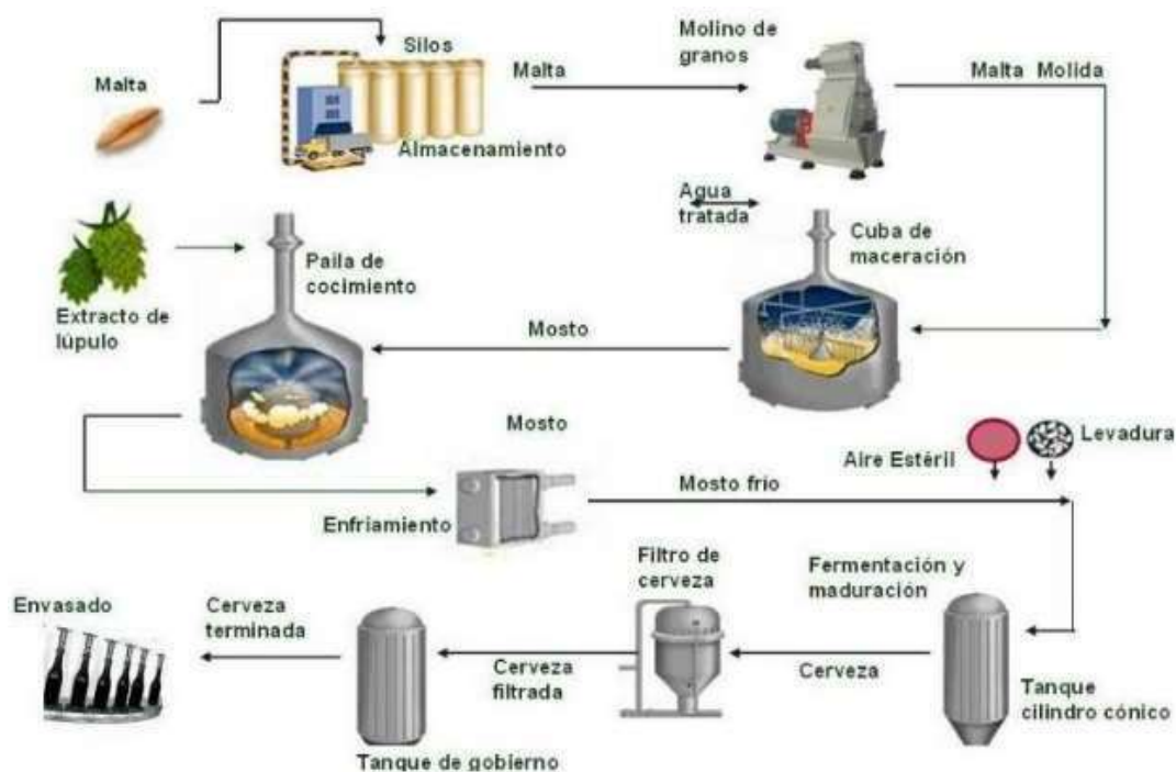
Figura 6. Equipos para la producción de la cerveza
