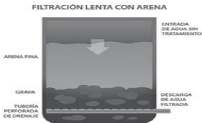
Imagen 2. Corte transversal de un filtro lento casero
