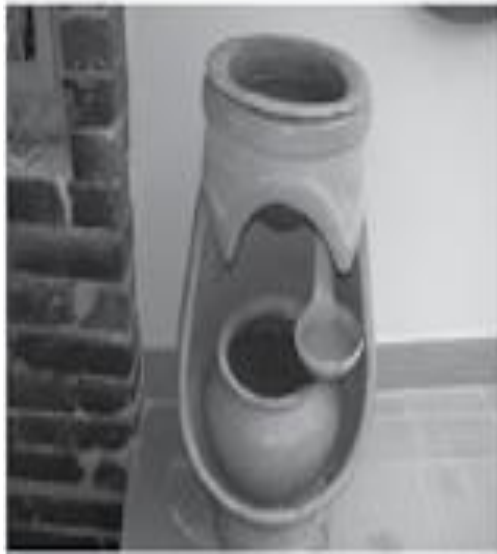
Imagen 5. Corte transversal de un filtro de cerámica
