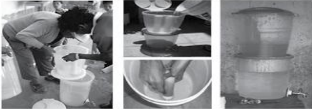
Imagen 3. Filtros de vela cerámica de fabricación casera
