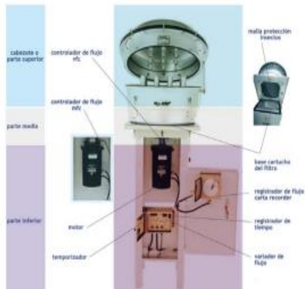
Figura 2. Partes y componentes de un muestreador de PM10, Fuente. Protocolo MAVDT,2008, P. 163.
