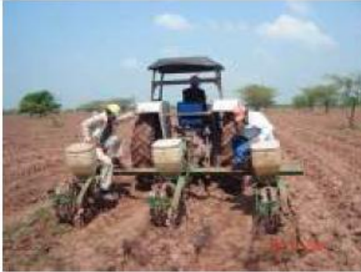
Figura 9. siembra mecanizada de pastos mejorados sobre los caballones
